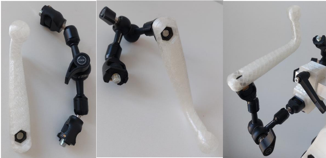
Figura 65. Ensamblaje del posicionador de palma.
