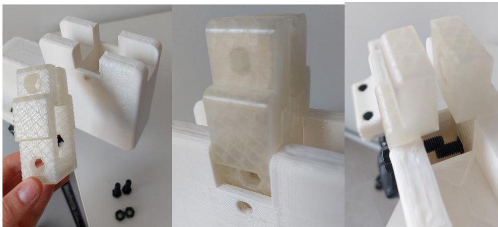
Figura 59. Unión de la sujeción de la guía al cuerpo.
