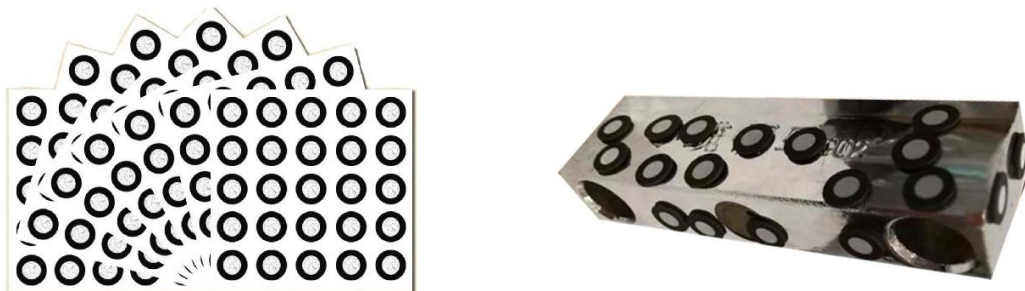
Figura 19. a) Adhesivos de marcadores o dianas. b) Ejemplo de adhesivos colocados sobre una pieza a modelar. [17]
