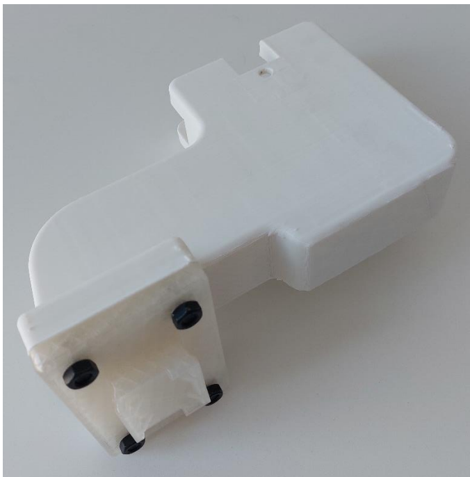
Figura 57. Ensamblaje del cuerpo y la pieza de sujeción del trípode.
