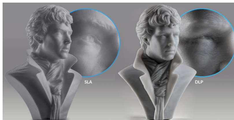
FIGURA 1.7. COMPARATIVA SLA Y DLP (FORMLABS, 2017).
