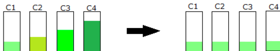
Figura 3. Equilibrado de celdas mediante métodos pasivos.
