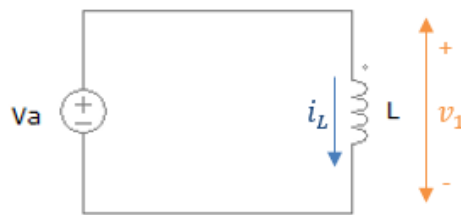
Figura 48. Modelo ideal del circuito de carga de la bobina.
