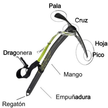
Ilustración 3: Partes del piolet ( https://www.barrabes.com/blog/consejos/2-10238/como-elegir-tus-piolet-montana )
