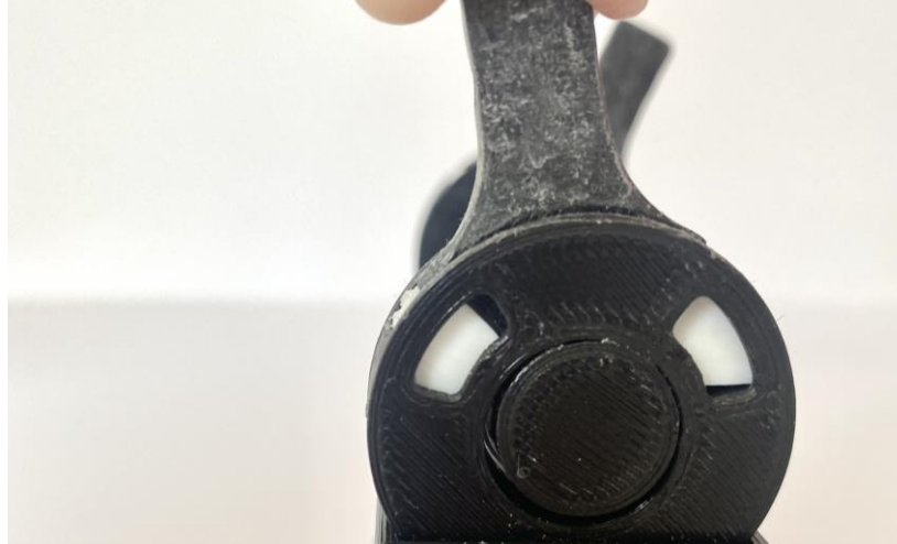
Fig. 37. Compresión de las unidades mediante el movimiento de la pieza de empuje
