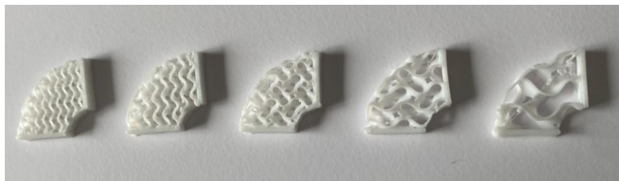
Fig. 44. Pruebas de impresión de TPU dureza 95 A con diferentes densidades de relleno
