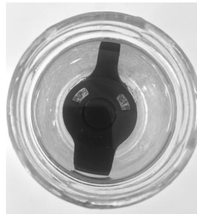
Fig. 40. Pieza impresa con el soporte. Introducción de la pieza en agua para la disolución del soporte
