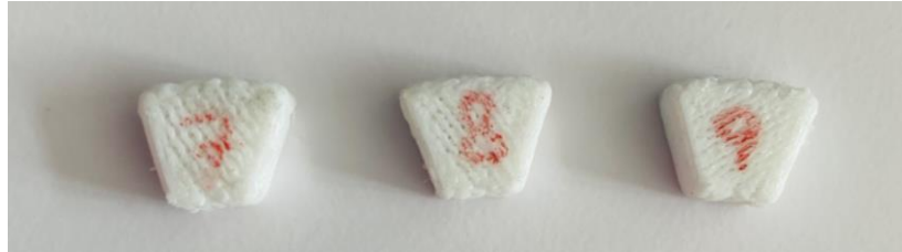
Fig. 47. Unidades de dureza Shore 82 A, modelos de densidad 70%(7), 80%(8) y 90%(9)
