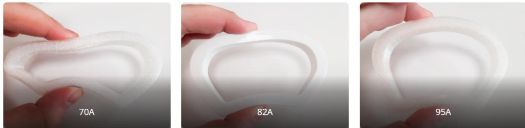
Fig. 42. Elasticidad de una misma pieza geométrica en función de la dureza del TPU
