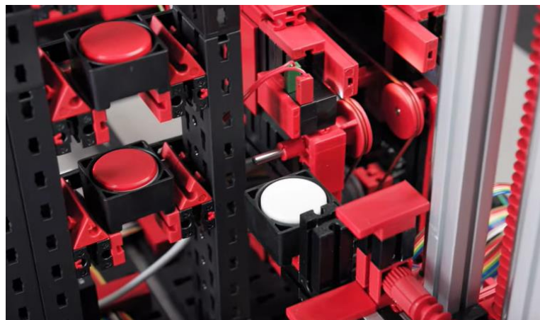
Figura 25. Transelevador del VGR almacenando la pieza.
