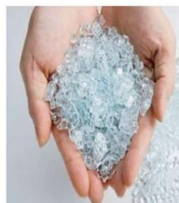
Ilustración 101: Rotura vidrio templado
