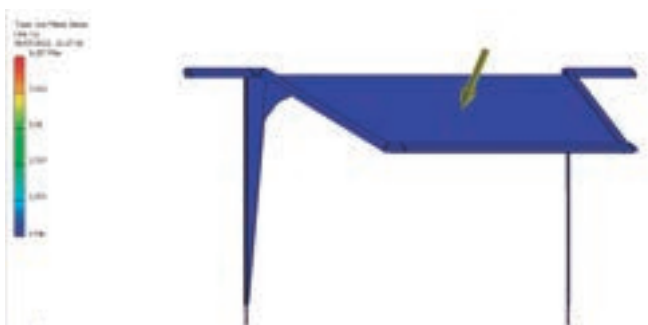
Imagen 61. Análisis estructural, tensión de Von Mises
