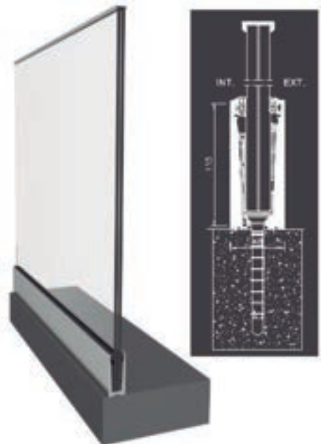
Imagen 47. Fijación rodapié al suelo
