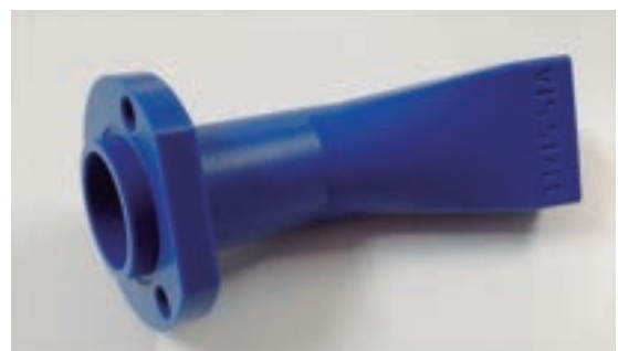
Imagen 64. Pieza de Nylon PA11 por sinterizado selectivo
