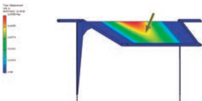
Imagen 60. Análisis estructural, desplazamiento
