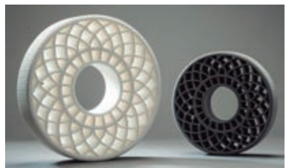
Imagen 63. Piezas de Nylon PA11 por sinterizado selectivo
