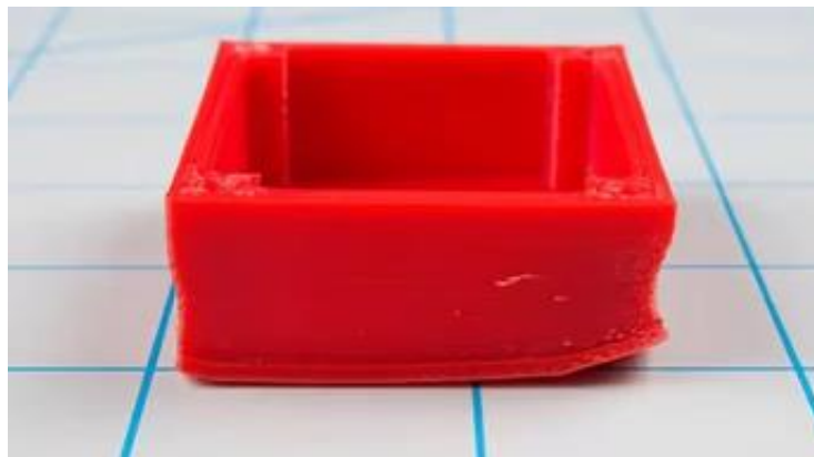
Ilustración 9: Pieza con defecto de warping.
