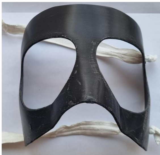
Ilustración 31: Máscara fabricada en PLA.
