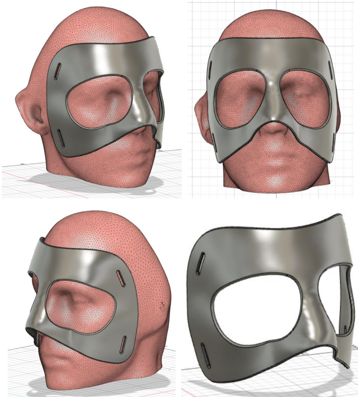
Ilustración 28: Diferentes perspectivas de la forma final de la máscara.
