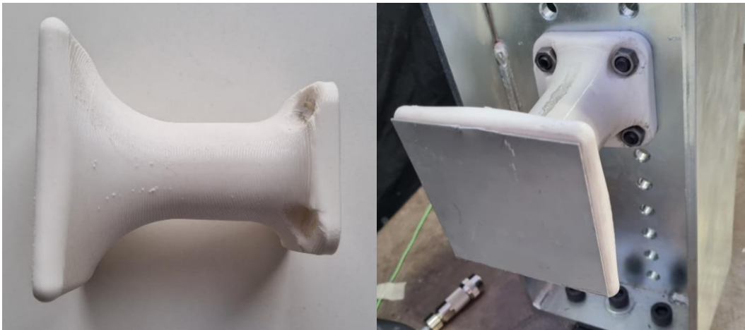
Ilustración 65: Pieza de contacto para simular el impacto.
