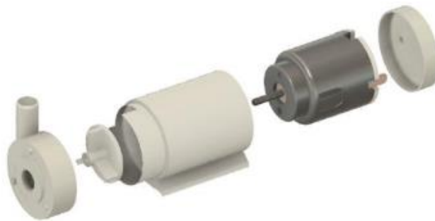
Figura 31. Construcción de la bomba sumergible.
