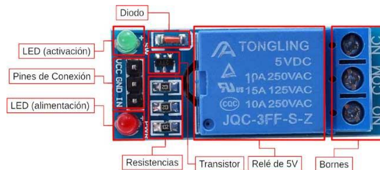
Figura 27. Partes del módulo relé simple.
