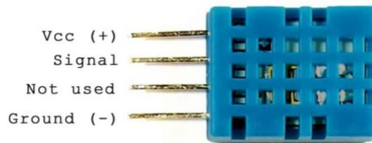
Figura 12. Pines del sensor DHT11.
