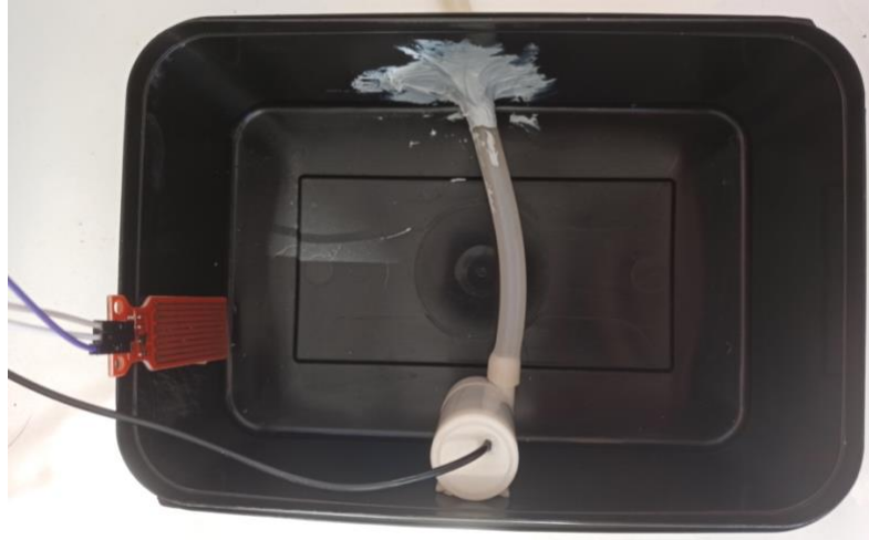
Figura 73. Depósito de agua con bomba y sensor de nivel.
