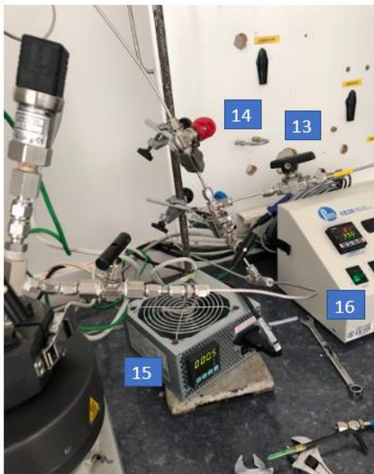
Figura 15. Conexión de N 2 y equipos de presión y temperatura.
