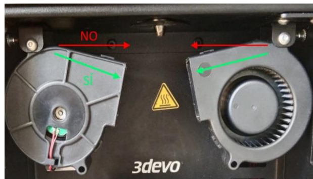
Figura 48. Orientación recomendada de los ventiladores (Fuente propia)
