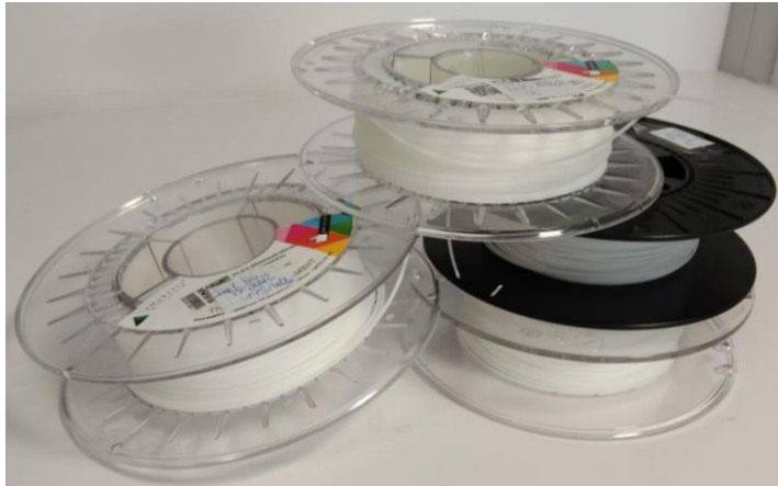
Figura 103. Bobinas de PP obtenidas con la filamentadora Fuente Propia
