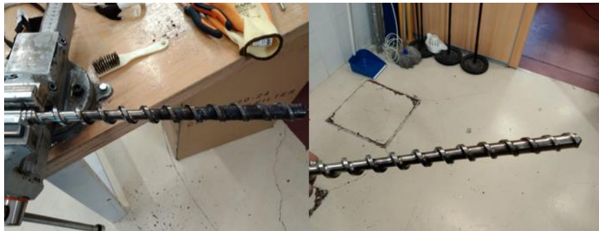
Figura 64. Tornillo sinfín carbonizado (izda) y tornillo sinfín limpio y pulido (dcha) Fuente propia
