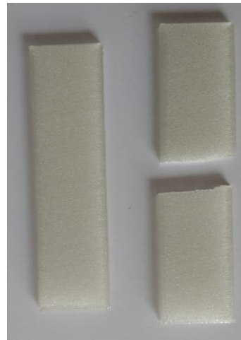
Figura 86. Probeta de PLA antes (izda) y después (dcha.) del ensayo a flexión. Fuente Propia
