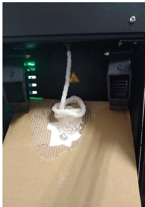
Figura 53. Proceso de purga de la filamentadora Fuente Propia
