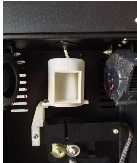
Figura 69. Prototipo de ventilación circular Fuente propia
