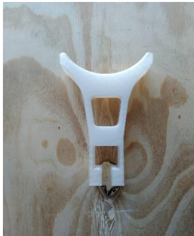
Figura 83. Pieza realizada mediante Impresión 3D con PLA (Experimento 1) (Fuente Propia)
