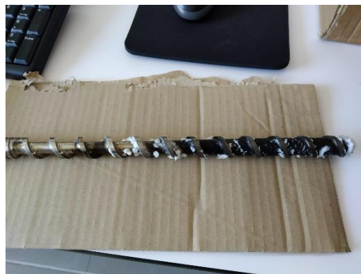
Figura 63. Tornillo sinfín contaminado. Fuente propia.
