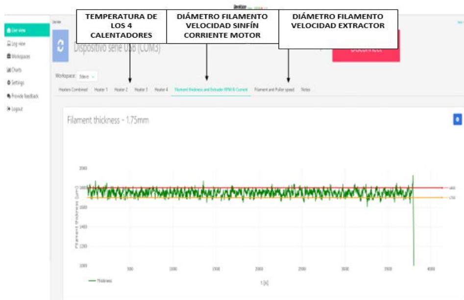
Figura 52. Pantalla de visualización de la Interfaz del software Devovision. Gráfica del diámetro del filamento. (Fuente propia)
