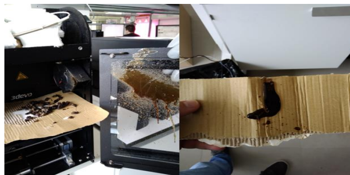
Figura 57. PLA degradado que provocó el accidente Fuente propia
