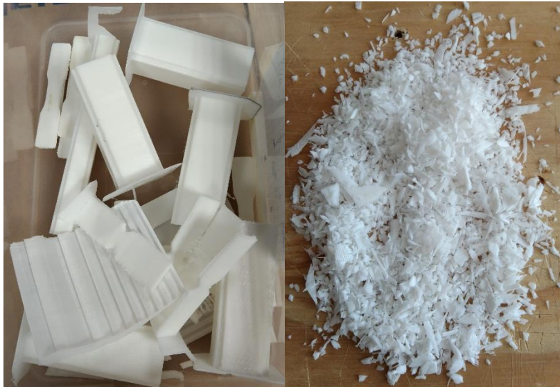
Figura 108. Piezas de PP antes(izda.) y después (dcha.) de la trituración. Fuente Propia
