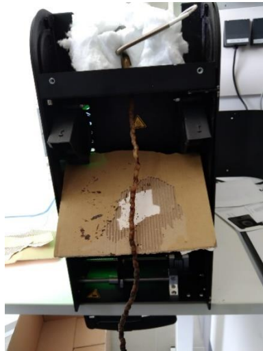
Figura 58. Material de purga mezclado con plástico degradado. Fuente propia
