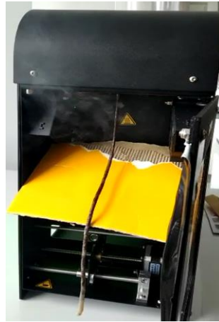
Figura 60. Purga de alto nivel. I Fuente propia
