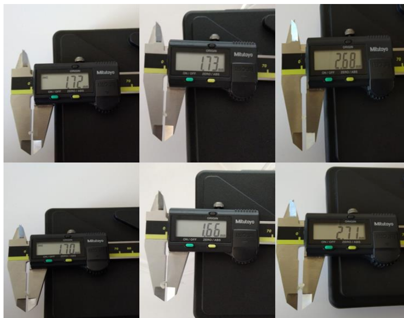
Figura 81. Diámetro medido con calibre (Experimento 1 (izda), Experimento 2 (centro), Experimento 3 (dcha.)) (PLA 3devo) Fuente Propia
