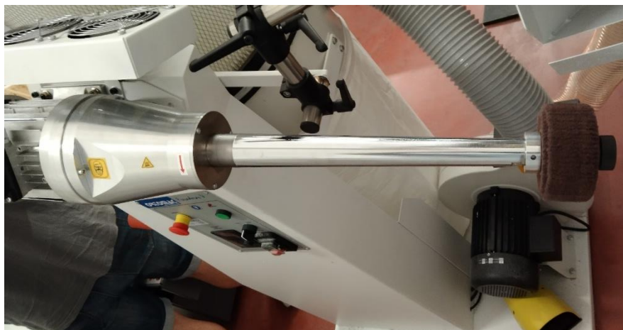
Figura 65. Fresadora con cabezal puesto para pulir el husillo Fuente propia
