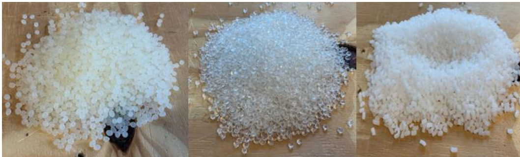
Figura 38. Pellets de PLA (izda), PETG(centro) y PP(dcha) Fuente Propia
