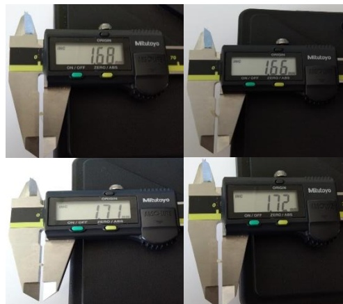
Figura 89. Diámetro medido con calibre (Experimento 1 (izda), Experimento 2 (dcha.)) (PLA SmartMaterials 3D) Fuente Propia
