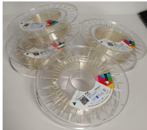
Figura 95. Bobinas de PLA (SmartMaterials 3D) obtenidas con la filamentadora. Fuente Propia
