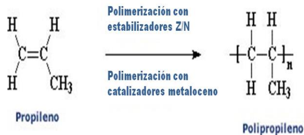
Figura 37. Obtención del polipropileno a partir de la polimerización del propileno. [19]
