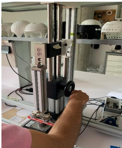
Figura 78. Realización de uno de los ensayos a flexión Fuente Propia
