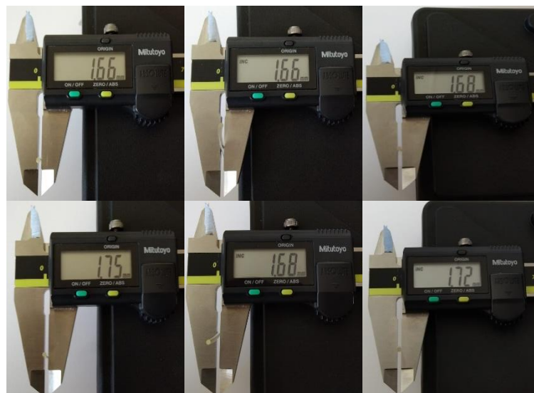
Figura 94. Diámetro medido con calibre (Experimento 4 (izda), Experimento 5 (centro), Experimento 6 (dcha.)) (PLA SmartMaterials 3D) Fuente Propia
