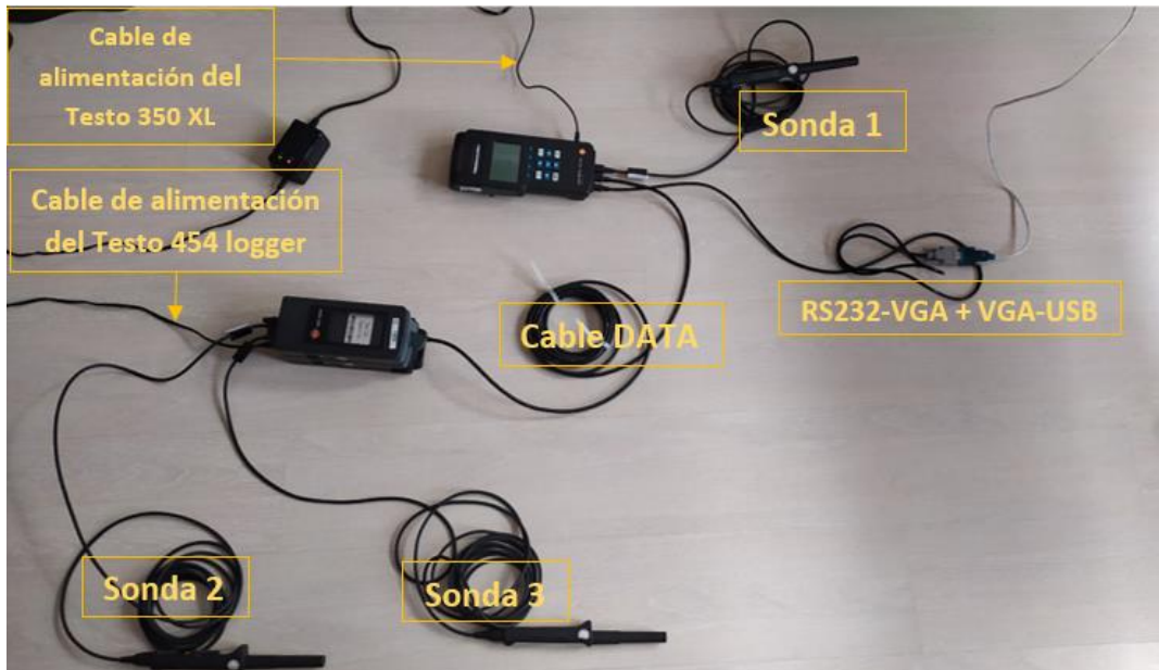
Figura 4. Conexión del equipo de medición de la concentración de CO 2 .
