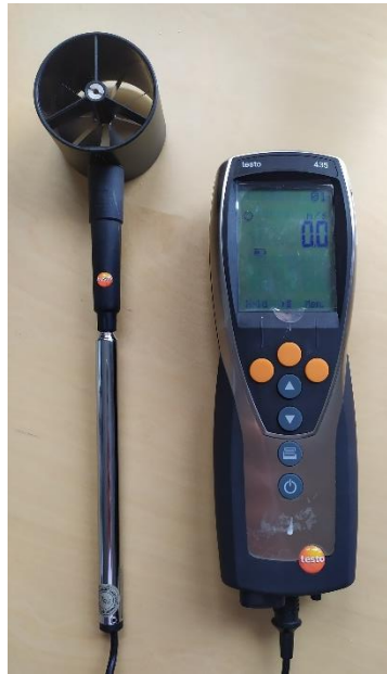
Figura 12. Sonda de molinete (a la izquierda) y data logger (a la derecha).
