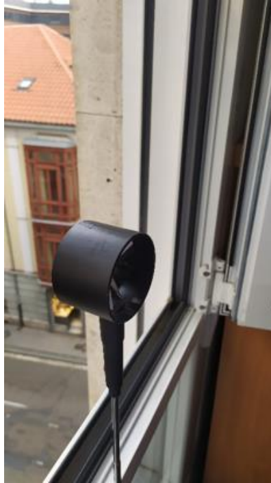
Figura 13. Colocación de la sonda de molinete.
