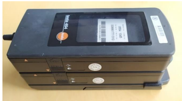
Figura 1. Powerbox (arriba) y Testo 454 logger (abajo) acoplados.
