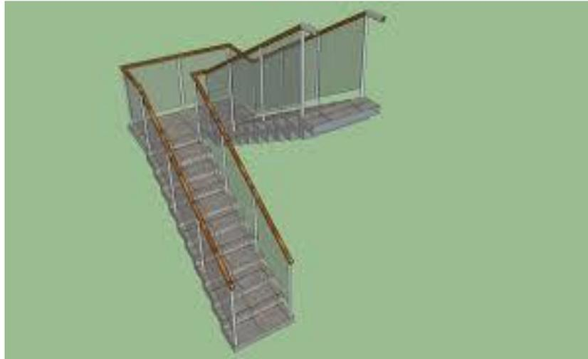
Figura 2-4 Escalera Recta de dos tramos con zancas paralelas realizada con SKETCHUP
