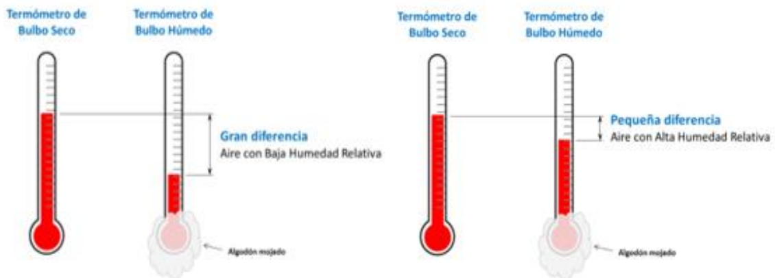
Figura 5. Diferencia de temperaturas con los distintos termómetros
