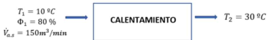
Figura 112 Proceso de calentamiento sensible de A.H
