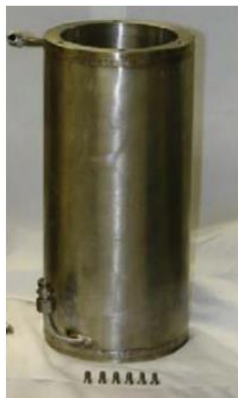
Figura 4.7 Cilindro de acero inoxidable de doble pared y criotermostato de circulación Julabo FP50-HE.
