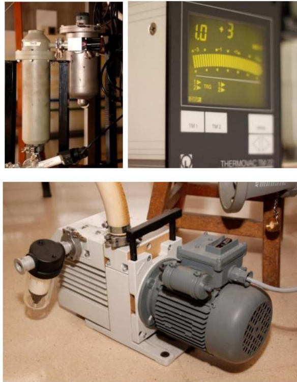
Figura 4.12 Elementos del sistema de generación de vacío: trampa de zeolitas, trampa criogénica, vacuómetro y bomba de vacío.
