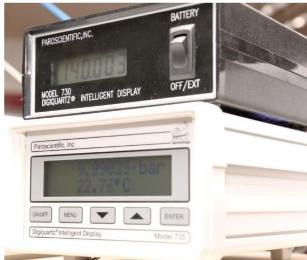
Figura 4.10 Transductores de presión para medida de la presión en el rango (2 - 20) MPa (arriba) y (0 - 2) MPa (abajo).
