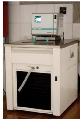
Figura 4.7 Cilindro de acero inoxidable de doble pared y criotermostato de circulación Julabo FP50-HE.
