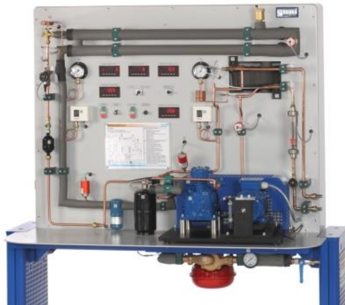
Figure 6. Machine frigorifique ET 351C Source : Documentation technique ET 351C
