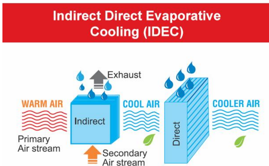
Figura 5: Esquema de funcionamiento de un sistema de enfriamiento evaporativo mixto Fuente: (HMX Ate Group, 2021)
