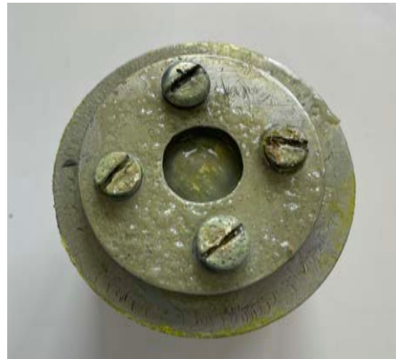
Figura 15. Filtro del precipitador tras la coprecipitación de rutina en Eudragit® en proporción 1:2.
