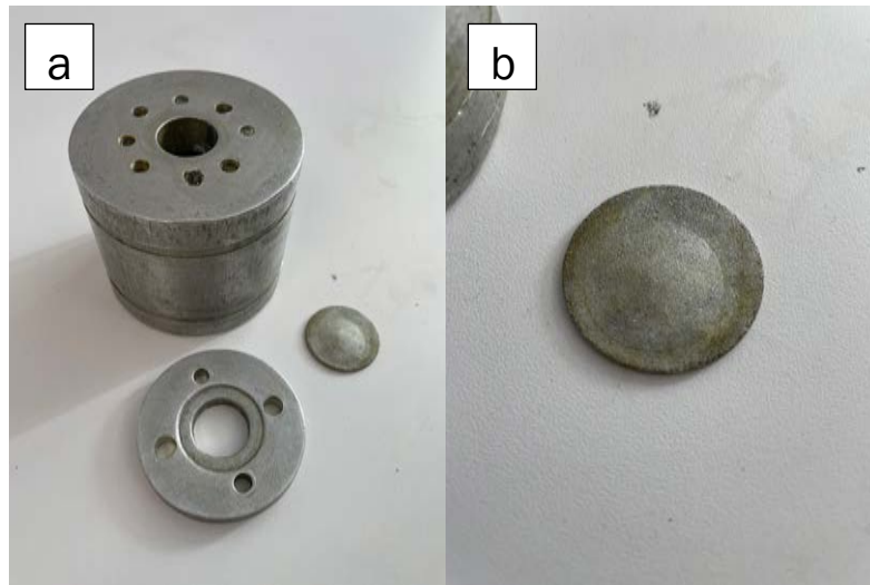
Figura 10. Filtro situado en la parte inferior del precipitador. (a) Componentes del filtro, (b) detalle del filtro metálico de partículas.
