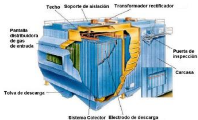
Figura 28. Partes de un precipitador electrostático
