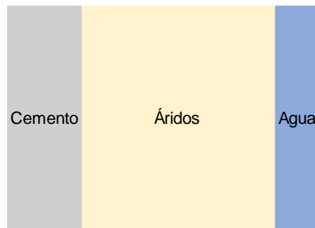
Figura 46. Esquema ilustrativo de la composición de un hormigón convencional [Elaboración propia]
