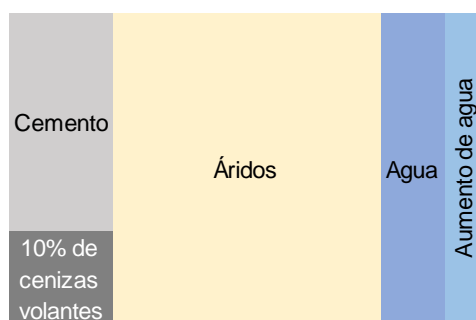
Figura 48. Esquema ilustrativo de un hormigón eco-eficiente con un 10% de sustitución de cemento por cenizas volantes [Elaboración propia]
