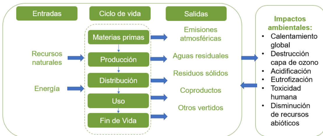
Figura 10. Esquema del análisis de inventario del ACV de un producto [Elaboración propia]
