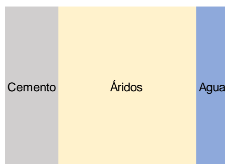
Figura 50. Esquema ilustrativo de la composición de un hormigón convencional
