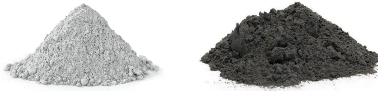
Figura 45. Comparación visual entre cemento (izquierda) y cenizas volantes (derecha)
