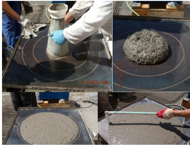
Figura 3. Ensayo del cono de Abrams para medir la consistencia del hormigón experimental con cenizas de biomasa como sustituto de filler en la composición del hormigón
