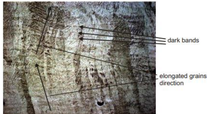
Figura 3.20. Granos columnares vistos en el plano general XZ según la dirección de escaneado unidireccional en zig-zag [33].
