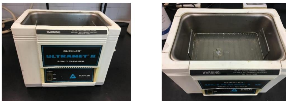
Figura 5.14. Máquina ultrasonidos Ultramet II. A la derecha, detalle de una probeta sumergida en el baño de ultrasonidos.
