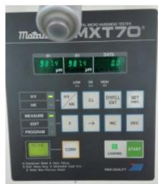
Figura 5.32. Pantalla del durómetro con las indicaciones de la longitud de las diagonales y el valor final de dureza Vickers.
