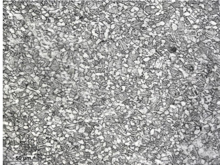
Figura 1.17. Microestructura bimodal típica en Ti6Al4V.
