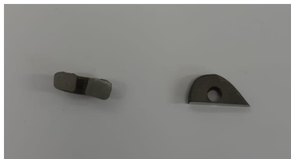
Figura 6.2. Corte de las muestras número 6 y número 7. a) Muestra cortada perpendicular respecto a la dirección del eje Z de fabricación; b) Muestra cortada paralelamente a la dirección del eje Z de fabricación.
