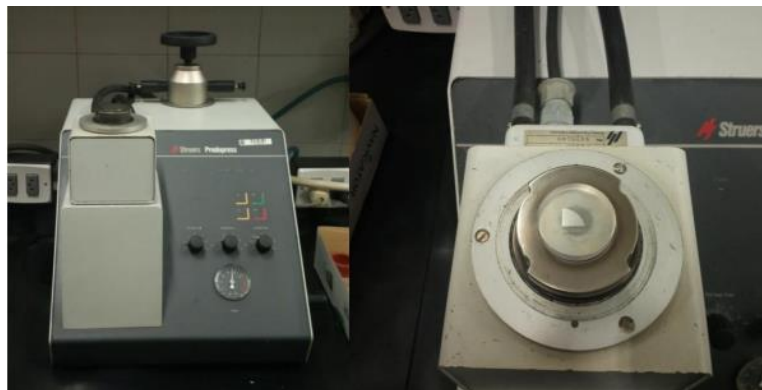
Figura 5.8. Máquina de empastillar Struers Predopress y posición de colocación de la muestra en la misma.
