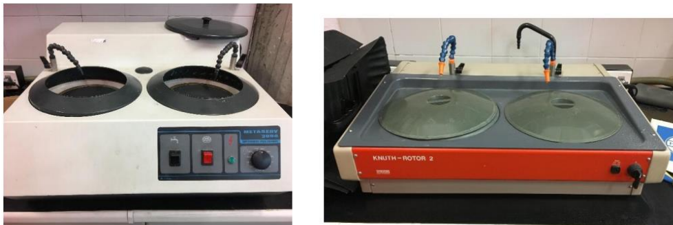
Figura 5.12. Máquinas de desbaste utilizadas con las respectivas lijas anteriores.
