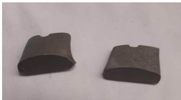
Figura 6.21. Muestra de Ti6Al4V después del método biomimético de deposición de HA.
