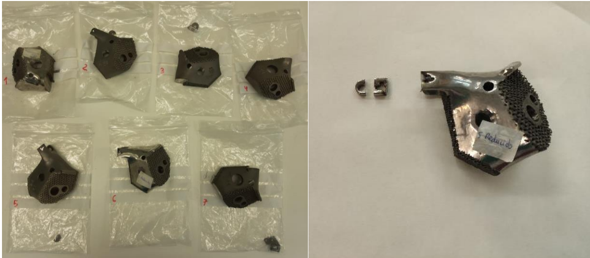
Figura 6.1. a) Muestras de Ti6Al4V fabricadas mediante SLM y EBM; b) Imagen del corte perpendicular a la dirección de fabricación del eje Z.
