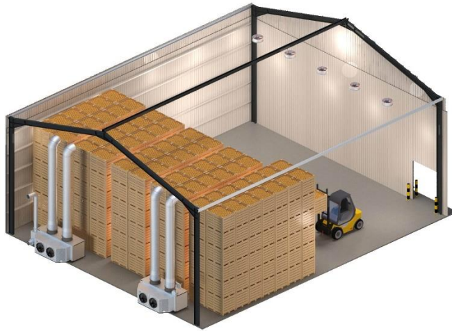
Imagen 1. Diseño interior de la cámara frigorífica.
