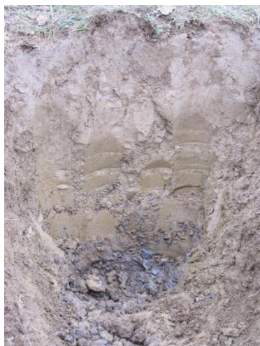
Imagen 11: Calicata realizada sobre el terreno
