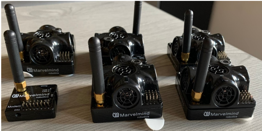
Figura 47. Componentes del sistema Marvelmind Indoor Positioning System
