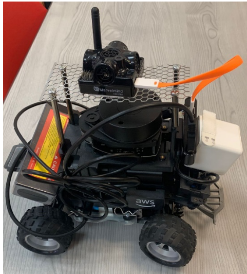
Figura 49. Montaje baliza Marvelmind en el coche AWS Deepracer
