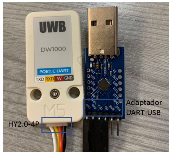
Figura 38. Conexión entre el módulo UWB y el adaptador UART-USB
