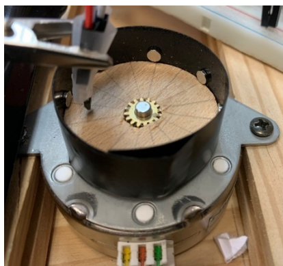
Figura 33. Rueda con imanes en circuito de pruebas
