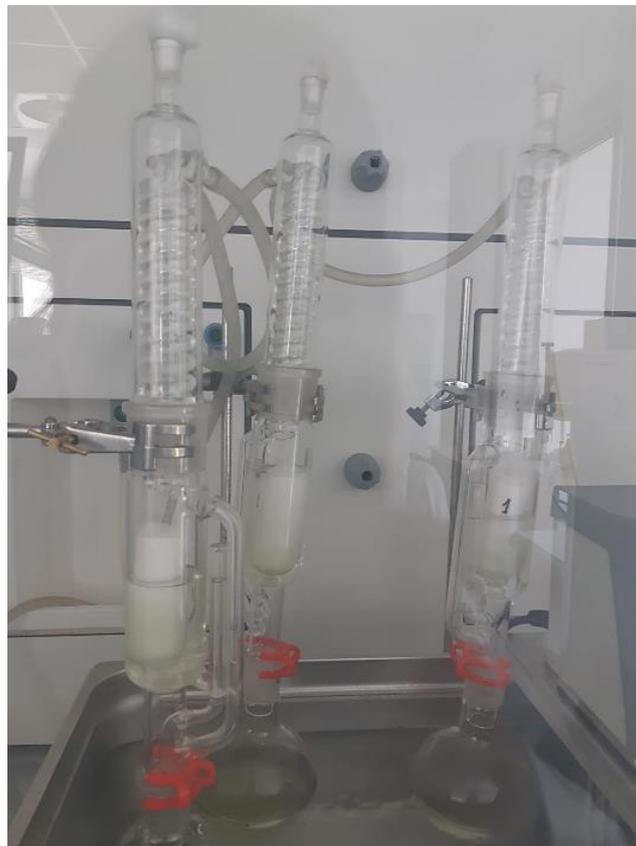
*Figura 19. Dispositivo soxhlet empleado para la extracción total de la fracción grasa de la harina de cáñamo mediante disolvente orgánico.*
