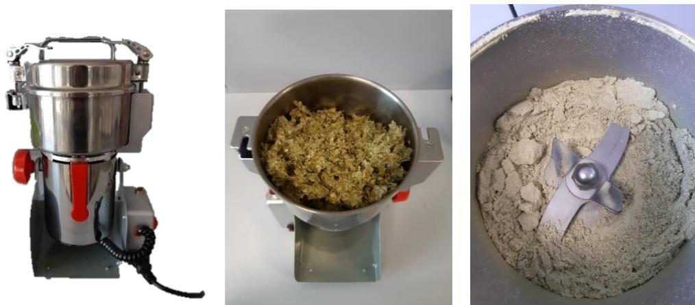
Figura 17. Molienda de la torta de cáñamo. Molino de aspas rotatorias (izquierda), disposición de la torta en el molino (centro) y harina obtenida tras el molido (derecha).
