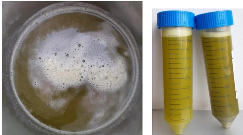
Figura 15. Aceite obtenido tras el prensado mecánico. Recipiente de recogida (izquierda) y aceite con impurezas (derecha).
