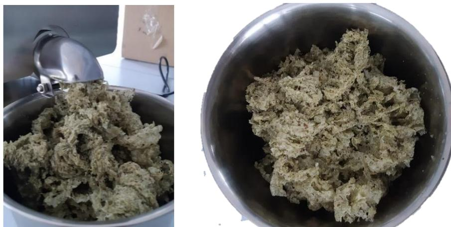
*Figura 14. Torta de cáñamo a la salida de la prensa (izquierda) y en el recipiente de recogida (derecha).*
