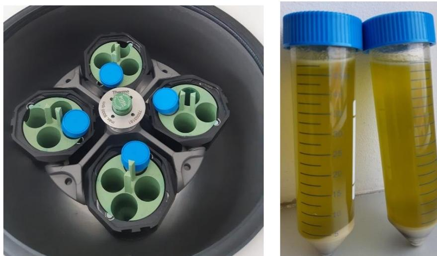
Figura 16. Centrifugación del aceite. Disposición de los tubos de aceite en la centrífuga (izquierda) y aceite final (derecha).
