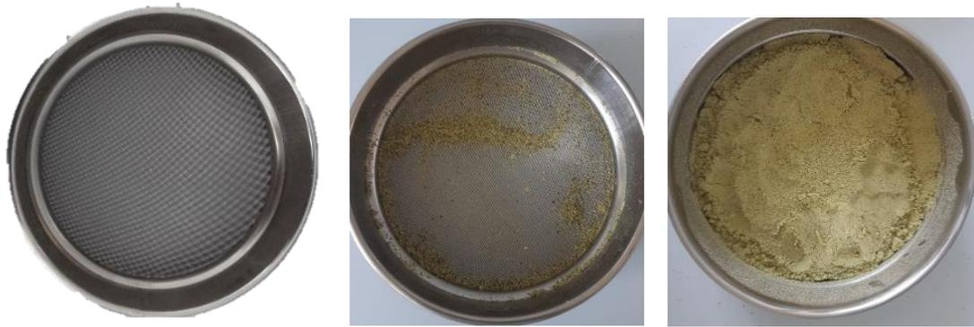
*Figura 18. Tamiz de 500  $\mu\text{m}$  de luz de malla (izquierda), fracción gruesa obtenida (centro) y harina final correspondiente con la harina de cáñamo parcialmente desgrasada que fue octeto de estudio (derecha).*
