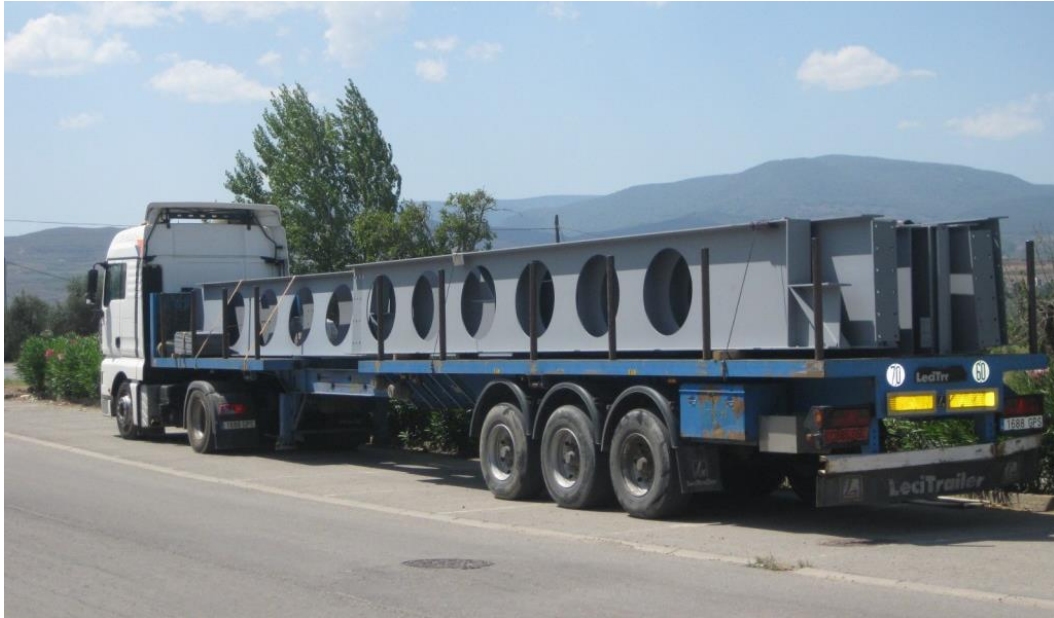
Figura 5. 29 Transporte de vigas boyd [21]
