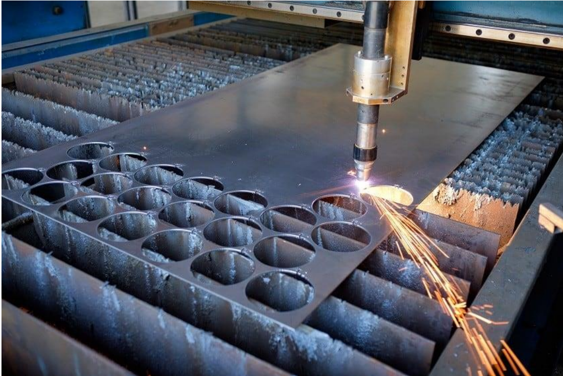
Figura 4. 4 Proceso de corte de una chapa de acero [22]
