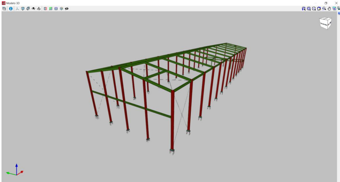
Figura 5. 24 - Estructura de la nave con pórticos IPE
