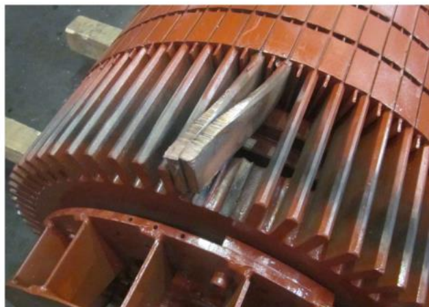
Figura 6: Protrusión en la jaula del rotor en un motor de 6 kV, 1400 kW primarios (motor de un ventilador) (stein, koegl, & Kliman, 1988).
