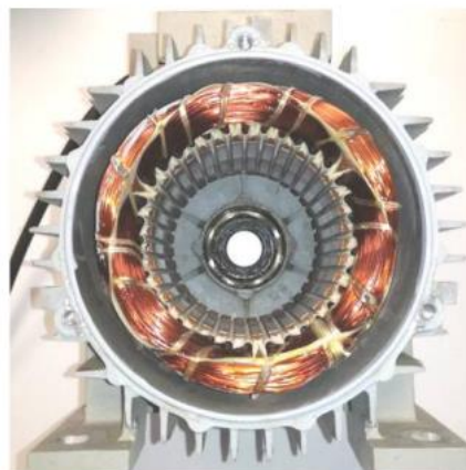
Figura 3: Estator de un motor de inducción. Fuente: (Herrera Guachamin, 2018)
