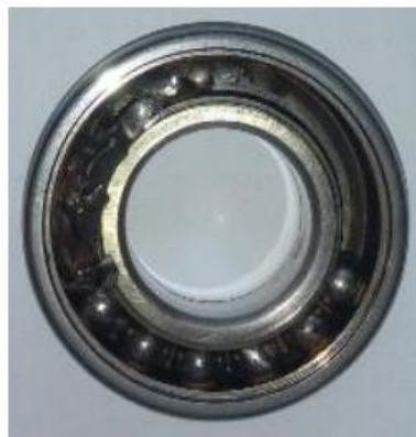
Figura 30: Rodamiento con fallo catastrófico.
