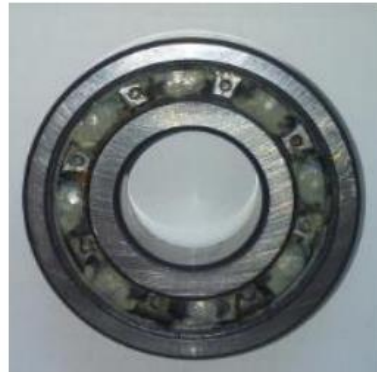
Figura 27: Rodamiento con fallo leve.
