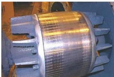
Figura 11: Rozamiento del rotor con el estator producido por excentricidades. Fuente: (Herrera Guachamin, 2018)
