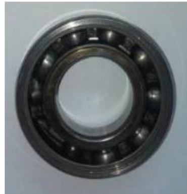
Figura 29: Rodamiento con fallo grave.
