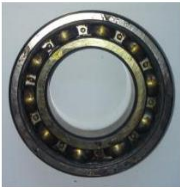
Figura 28: Rodamiento con fallo moderado.
