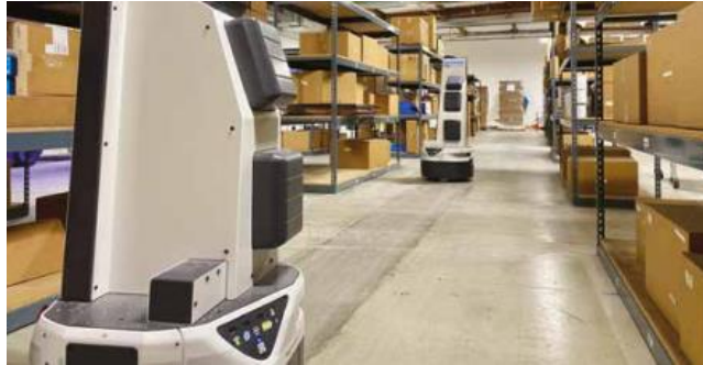
Ilustración 32. Robots móviles autónomos con lectores RFID(Heuter & Kueckelhaus, 2020).
