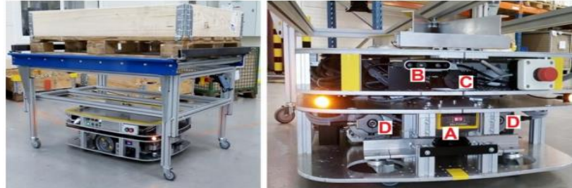
Ilustración 24. Robot móvil autónomo bajo el carro de transporte (Stączek et al., 2021)
