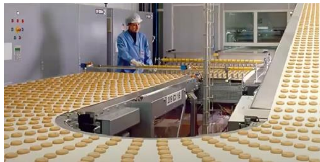
Ilustración 22. Arrastradores de las bandejas de galletas (Sinovac, 2022)
