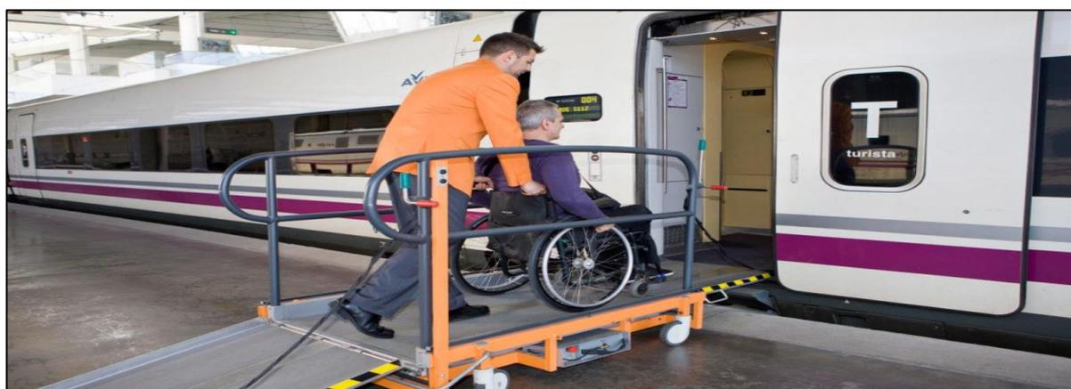
Figura 3.20: Ejemplo de puerta accesible en el transporte ferroviario /Fuente: Truecalia.com
