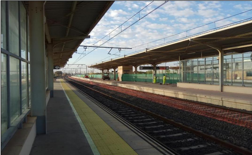
Figura 5.90: Pavimiento con color amarillo en un andén
