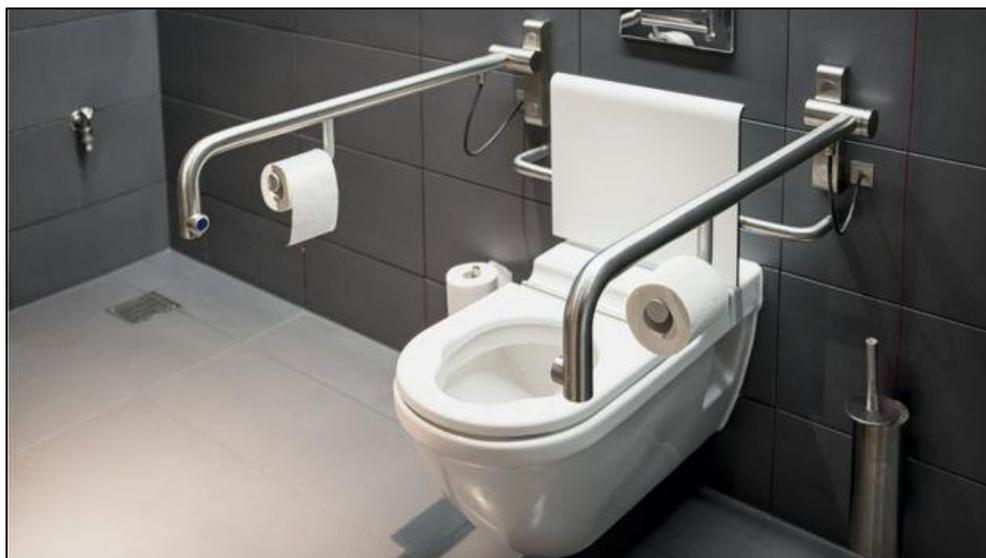
Figura 5.83 Barras de apoyo en aseo accesible
