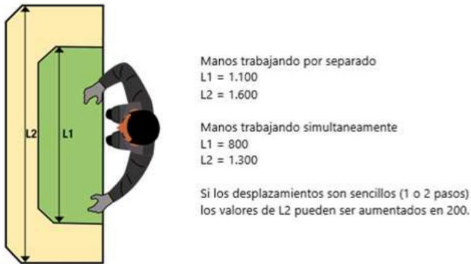
Figura 28: Dimensiones posición del operario en la ventana ergonómica en planta (HSEE Division, 2020)
