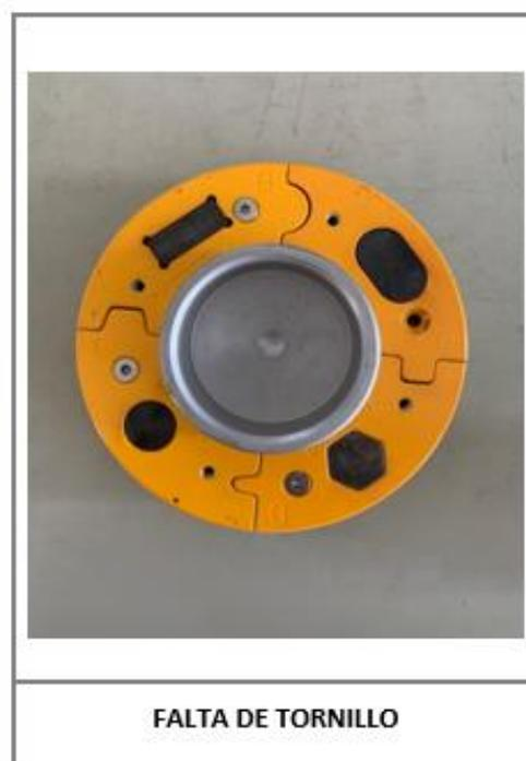
*Ilustración 62: Falta de tornillo*
