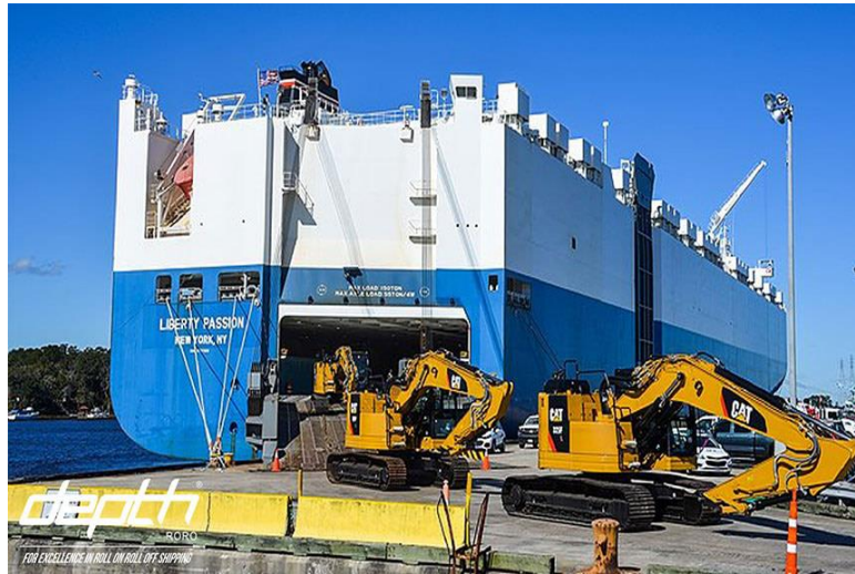
Ilustración 8: Carga de maquinaria pesada al buque Ro-Ro
