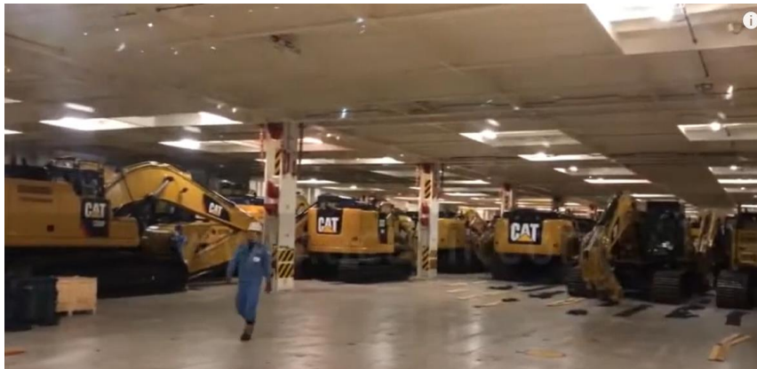
Ilustración 13: Ubicación de maquinaria pesada dentro del buque Ro-Ro
