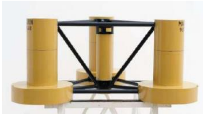
Figura 43. Plataforma semi sumergible utilizada. Series WFAE de NAVANTIA (El Ferrol).
