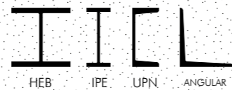
FIG.66_Perfilería metálica en steel frame FUENTE_elaboración propia
