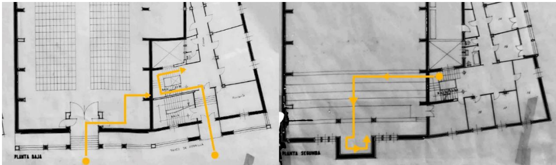
Fig. 41 Esquema de acceso y recorridos en planta baja y de coro. Algunos pasos difieren en la realidad con el proyecto original. Fuente: Modificación cromática y foto-montaje de fragmentos de los planos originales de Julio González https://jgonzalez.archivosarquitectos.com/es/original/project/3 consultado junio de 2022
