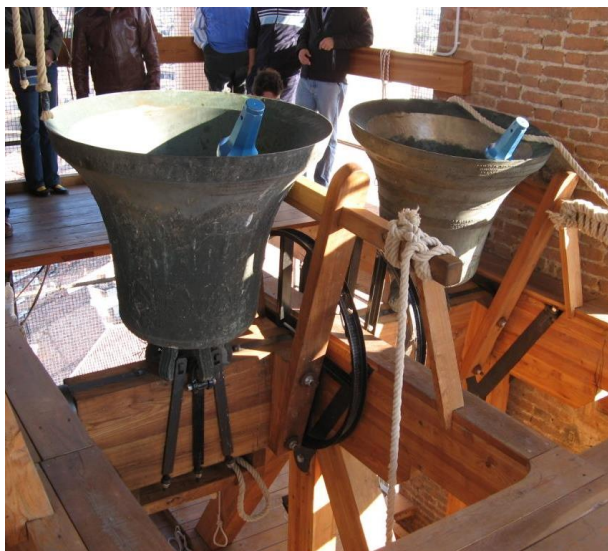
Fig. 1 Campanas en 'sistema bolognese'. Fuente: campanologia.org/sistemi-italiani/il-sistema-bolognese. consultado el 03-VII-2022
