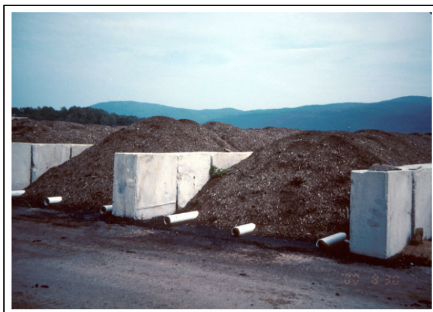
Figura 5: Pila estática con tubos para aireación [31].
