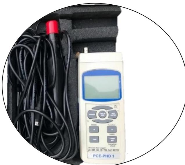
Figura 31. Dispositivo PCE-PHD 1, para la medición de parámetros fisicoquímicos del agua. Fuente: Carlos Escudero Ortega, 2022.
