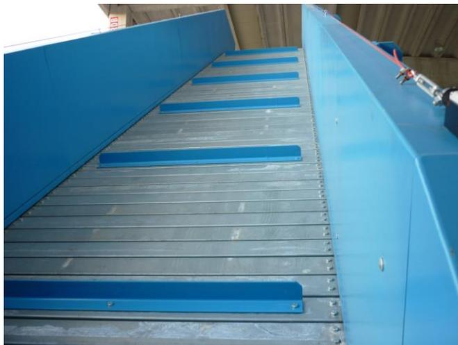
*Figura 32. Ejemplo de cinta transportadora de planchas metálicas [81].*
