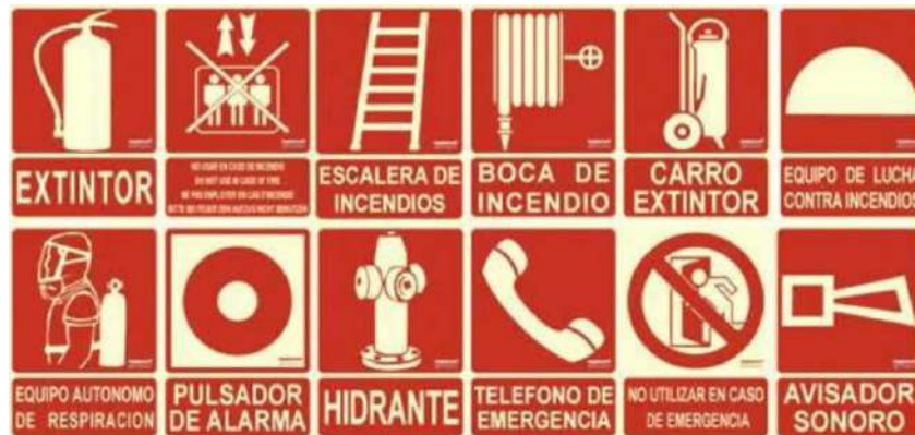
Ilustración 5. Señalización de los elementos de protección contra incendios.
