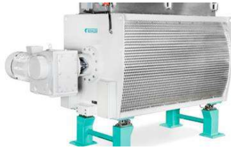
Ilustración 5. Mezcladora en seco
