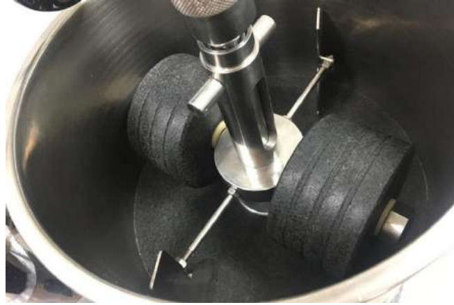
Ilustración 9. Doble hélice en conchadora.
