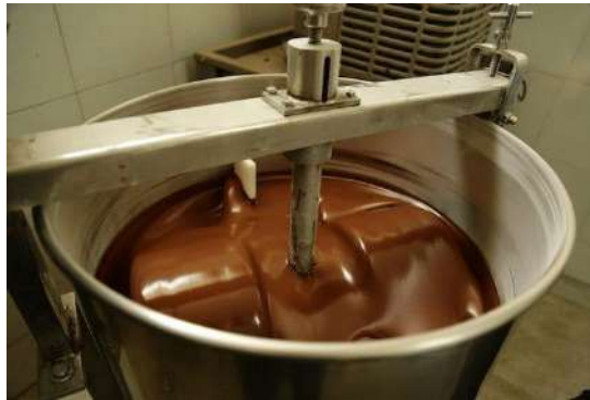
Ilustración 4. Fase líquida conchado.
