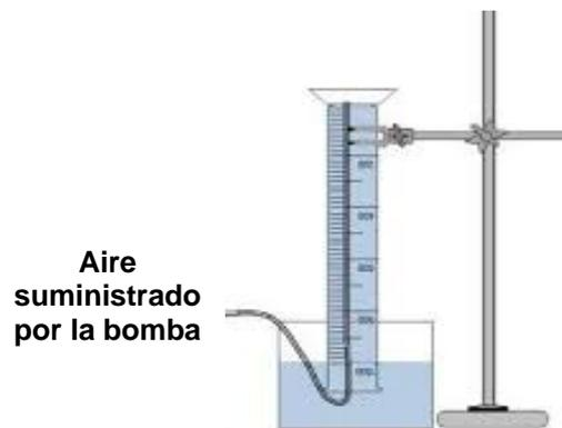
**Figura 2.4.** Representación de la prueba de la probeta invertida [43].
