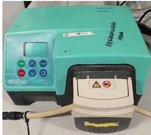
**Figura 2.3.** Bomba empleada en la calibración de los medidores.
