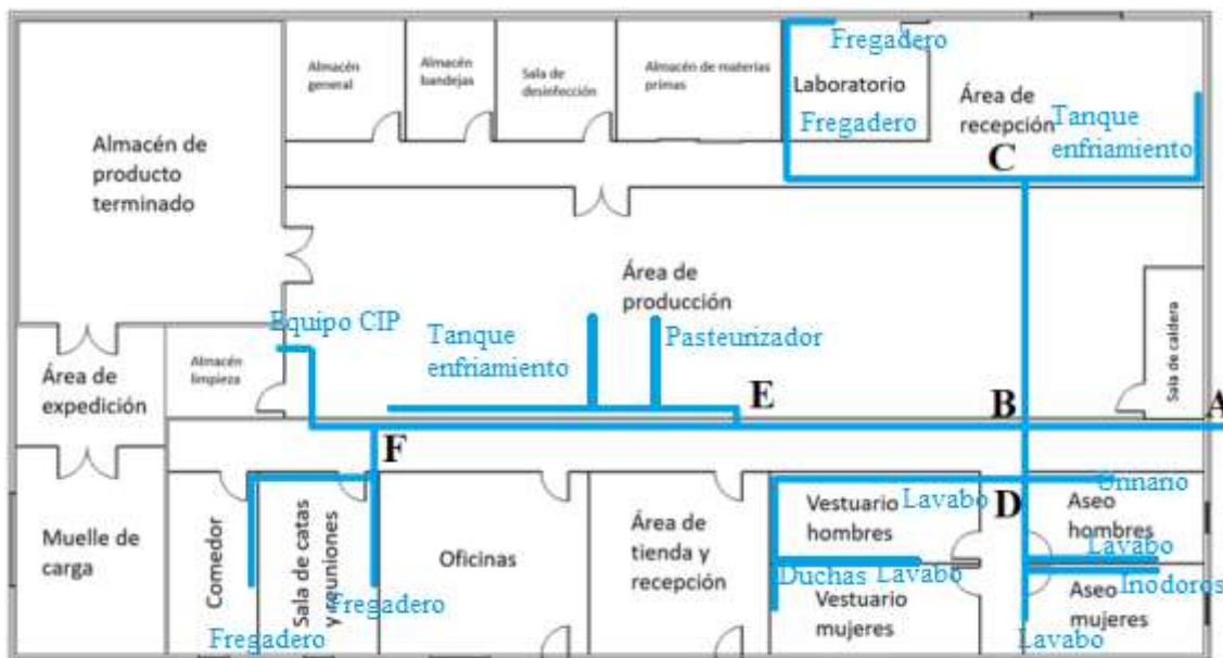
Ilustración 1: Croquis orientativo para instalación de agua fría
