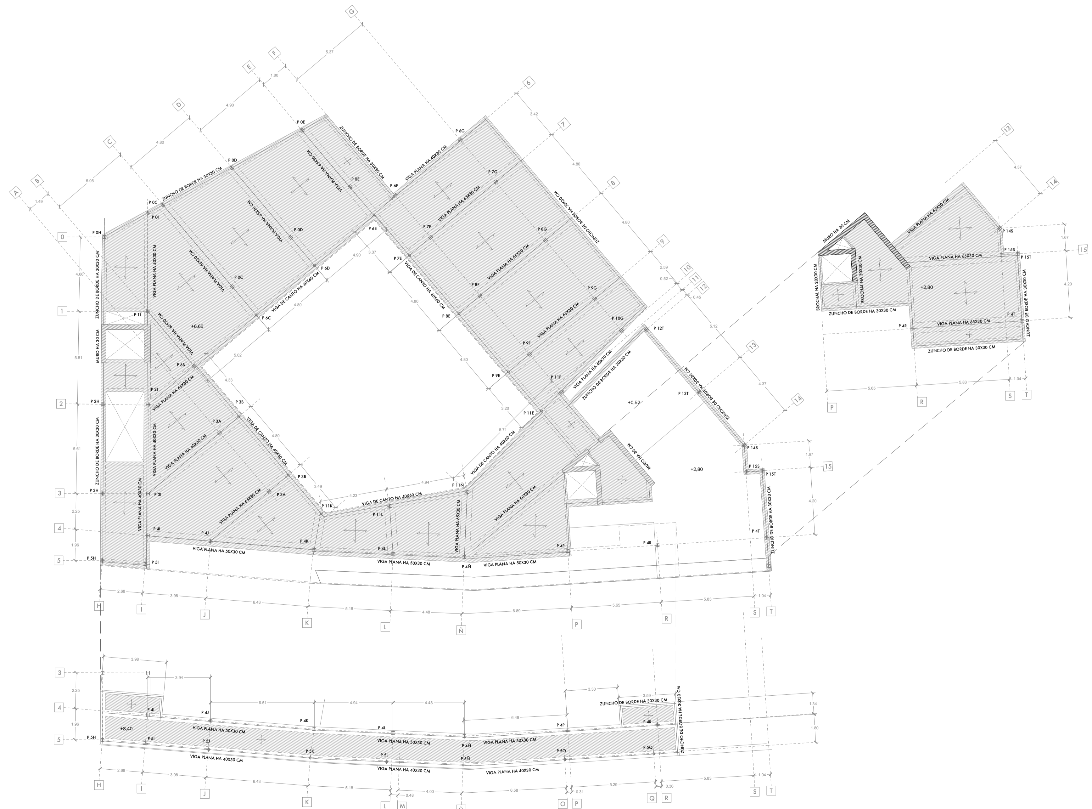
SUELO DE PLANTA PRIMERA (cota +6,65) con SUELO DE ENTREPLANTA (cota +2,80) y SUELO DE DOBLE ALTURA (cota +8,40), e 1:150
