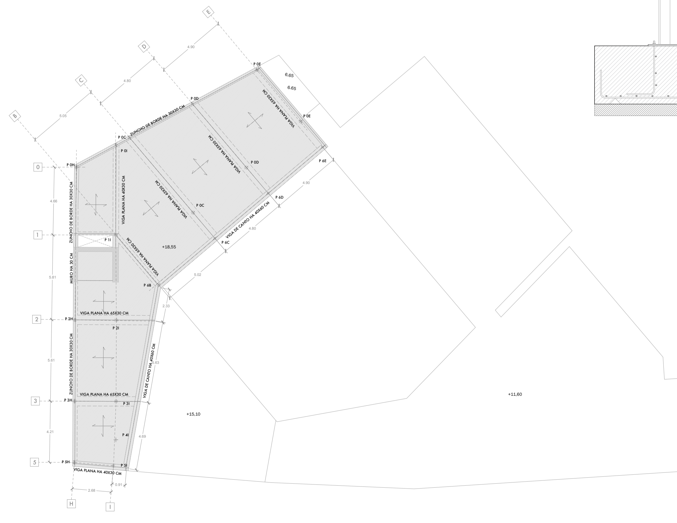
■ SUELO DE PLANTA CUBIERTA (cota +18,55), e 1:150
