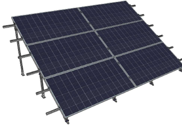
Figura 21: Esquema del soporte inclinado de los módulos fotovoltaicos. Modelo Varifix de Würth.
