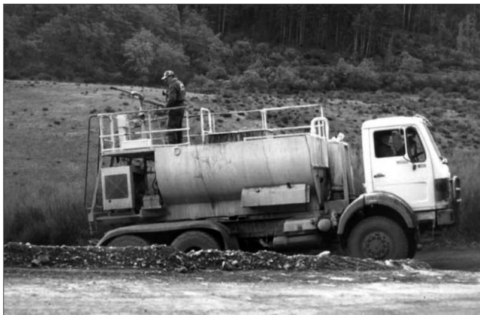
Figura 9.4. Hidrosementadora e ao fondo ladeiras hidrosementadas (foto: J. Navarro)
