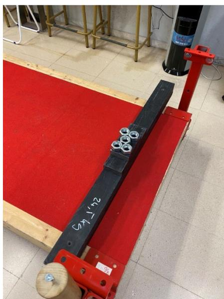
Figura 18. Acero equivalente a la masa del peatón
