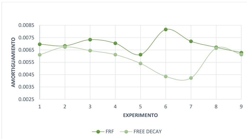
Figura 74. Comparación de amortiguamientos en el dominio del tiempo y de la frecuencia. Ensayo sentado
