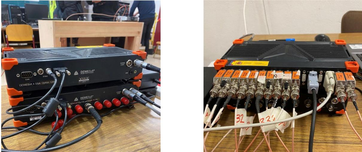
Figura 7. Sistema de adquisición de datos
