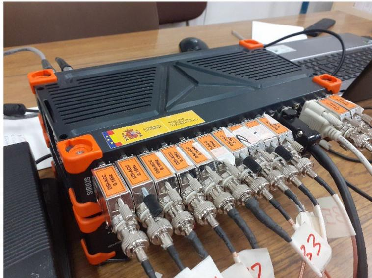
Figura 11. Sistema de adquisición de datos SIRIUS con adaptadores DSI.
