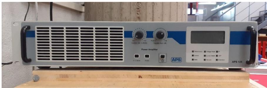
Figura 14. Amplificador de la señal dirigida al shaker.
