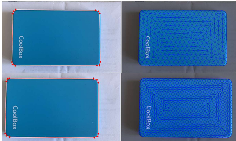
Figura 37. Diferentes mallados para un mismo contorno. Mallado con resolución 0.1 (Parte superior) y mallado con resolución 0.9 (Parte inferior)
