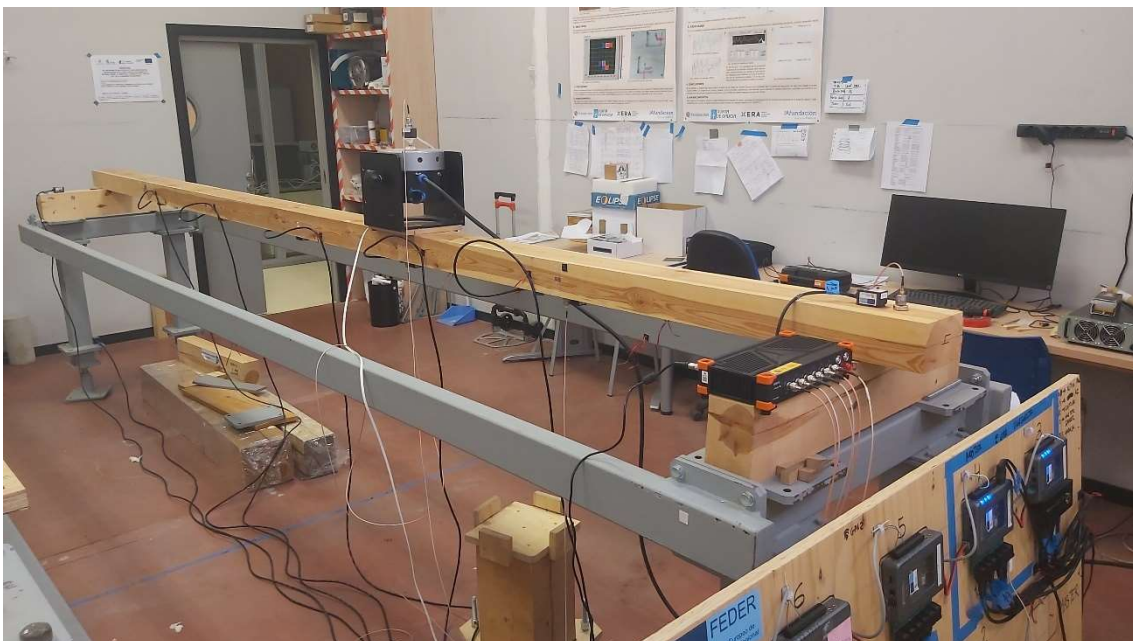
Figura 6. Fotografía de la viga biapoyada con el sistema de adquisición de datos incorporado.
