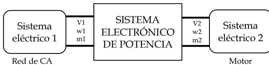
Figura 1. Concepto de Sistema Electrónico de Potencia. Elaboración propia
