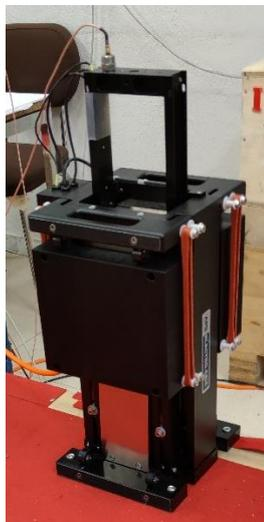
Ilustración 11. Shaker del laboratorio
