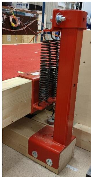
*Ilustración 2. Apoyo central plataforma laboratorio*
