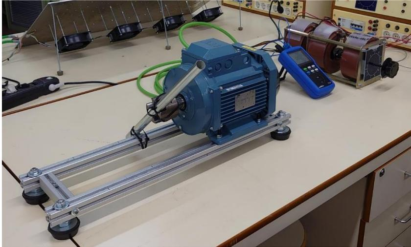
Figura 23. Instalación para ensayo de cortocircuito.
